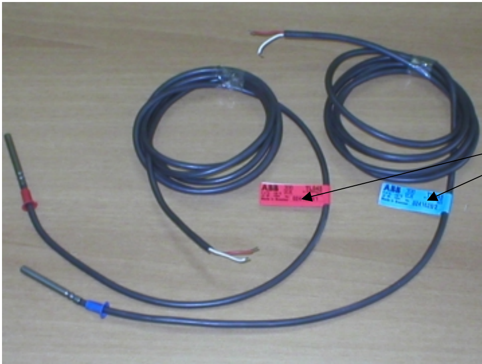
Slika 3: Mjerilo temperature mjerila toplinske energije tipa Pt 100 s trajno spojenim signalnim vodovima
