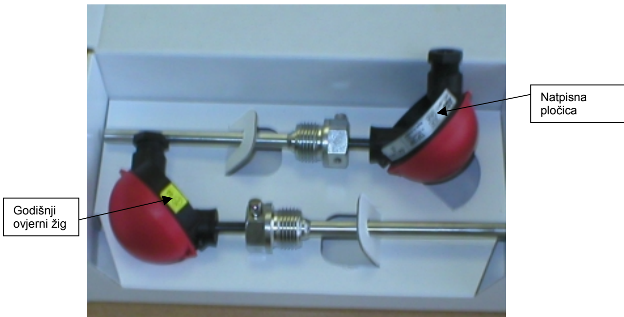
Slika 2: Mjerilo temperature mjerila toplinske energije tipa Pt 100 s glavom
